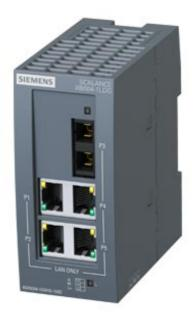
SCALANCE XB004-1LDG commutateur Industrial Ethernet non managé pour 10/100/1 000 Mbit/s; pour le montage de petites structures en étoile et et structures linéaires; diagnostic LED, IP20, 24V CC en tension redondante, avec 4x 10/100/1000 Mbit/s ports RJ45 électriques et 1 x 1 000 Mbit/s port SC optique (monomode, verre), jusqu'à max. 10km manuel disponible en téléchargement
