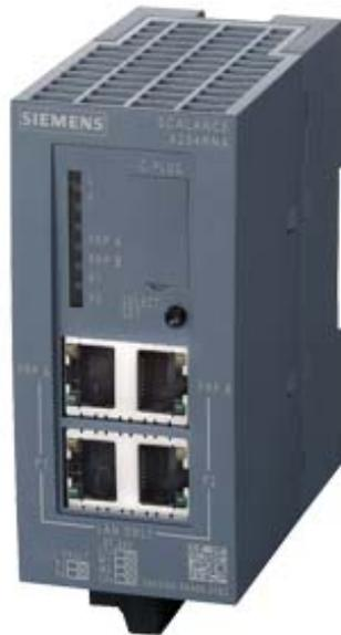
SCALANCE X204RNA; redondant accès réseau; 4x 100 Mbit/s ports RJ45; biagnostic LED; contact de signalisation de défaut avec bouton Set; alimentation en tension; gestion de réseau; incl. manuel électronique sur CD-ROM, C-PLUG en option pour réseaux PRP;
