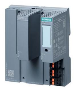
XF204-2BA IRT commutateur managé IE IRT, 4 x 10/100 Mbit/s, 2 x interfaces adaptateur de bus, contact de signalisation de défaut, avec bouton Set, alimentation 24 V CC en tension redondante, PROFINET périphérique IO, gestion de réseau, gestionnaire de redondance intégré, incluant manuel électronique sur CD-ROM, C-PLUG en option
