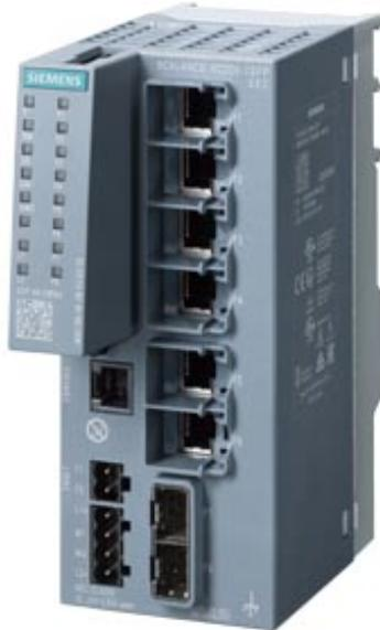
SCALANCE XC206-2SFP EEC commutateur IE couche 2 gérable homologué CEI 62443-4-2 ; 6x ports RJ45 10/100 Mbit/s ; 2x 100/1000 Mbit/s SFP ; 1x port console ; LED de diagnostic ; alimentation redondante ; avec circuits imprimés vernis; conforme NAMUR NE21, plage de température -40°C à +70°C ; montage: sur rail DIN symétrique/profilé support S7/mural ; fonctions de redondance; Office Features (RSTP, VLAN,...); périphérique PROFINET IO ; conforme Ethernet/IP, Logement C-PLUG ;
