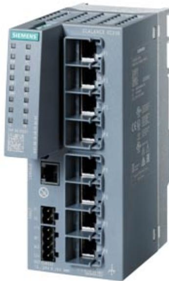
SCALANCE XC208 Commutateur IE couche 2 gérable ; homologué CEI 62443-4-2 ; 8x ports RJ45 10/100 Mbit/s ; 1x port consoles ; LED de diagnostic ; alimentation redondante ; plage de température -40°C à +70°C ; montage: sur rail DIN symétrique/profilé support S7/mural
