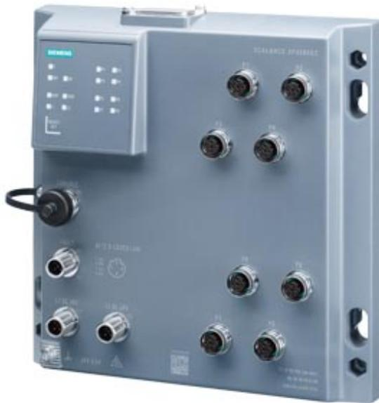
SCALANCE XP208PoE EEC, managed IE Switch, 8x 10/100 Mbit/s homologué CEI 62443-4-2 ; ports M12, IP65 LED de diagnostic, contact de signalisation de défaut, alimentation redondante, périphérique PROFINET IO, gestion de réseau, utilisable en anneau redondant, capuchon antipoussière, incl. manuel électronique sur CD-ROM, C-PLUG en option
