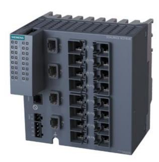
SCALANCE XC216-4C Commutateur IE couche 2 gérable; homologué CEI 62443-4-2; 12x 10/100 Mbit/s ports RJ45, 4x 1 000 Mbit/s ports combo; (SFP 1000 Mbit/s ou ports RJ45 10/100/1000 Mbit/s utilisables); 1x port console; LED de diagnostic; alimentation redondante; plage de température -40°C à +70°C; montage: sur rail DIN symétrique/profilé support S7/mural; fonctions de redondance; Office Features (RSTP, VLAN,...); périphérique PROFINET IO; conforme Ethernet/IP, Logement C-PLUG;
