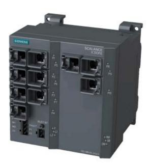
SCALANCE X310FE, managé plus IE, 10x 10/100 Mbit/s ports RJ45, diagnostic LED, contact de signalisation de défaut avec bouton Select/Set PROFINET IO Device, gestion de réseau, gestionnaire de redondance intégré, fonctionnalités Office (RSTP, VLAN, IGMP,...) C-PLUG fourni à la livraison
