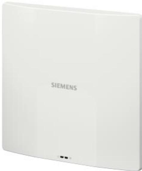
Point d'accès WLAN, SCALANCE W1750D-2IA RJ45, 2 radios, fonctionnement du contrôleur sans WLC, antennes internes, IEEE802.11ac wave2 AP, MU-MIMO, brut jusqu'à 800 Mbit/s (2,4 GHz) brut jusqu'à 1,7 Gbit/s (5 GHz), 2x RJ45, PoE, USB, 0 à +50 °C, respecter l'homologation nationale ! ID CERT comprenant : MPCIE Contenu de la livraison : DVD, guide de démarrage rapide (ang) Manuels Fixation au plafond Type : RoW
