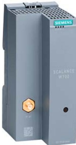
point d'accès IWLAN, SCALANCE W761-1 RJ45, 1 radio, 1 prise d'antenne R-SMA, IEEE 802.11a/b/g/h/n, 2,4/5GHz, débit de données brut 150 Mbit/s, 1x RJ45 max. 100 Mbit/s 24 V CC, bornier, IP20, 0 ... +55°C, WPA2/802.11i/e, Respecter les homologations nationales ! ID CERT: ELN-W1-RJ-E1, Contenu de la livraison : manuels sur CD-ROM allemand/anglais, 1x bornier; pour une mise en œuvre aux Etats-Unis uniquement
