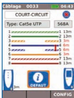
Schéma de câblage en échec
