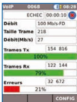
Test VoIP en échec - perte
